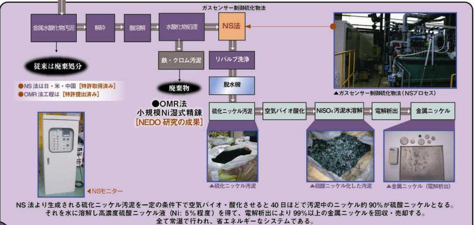
金属水酸化物汚泥の削減とニッケル回収・リサイクル (NS法+OMR法) 2
